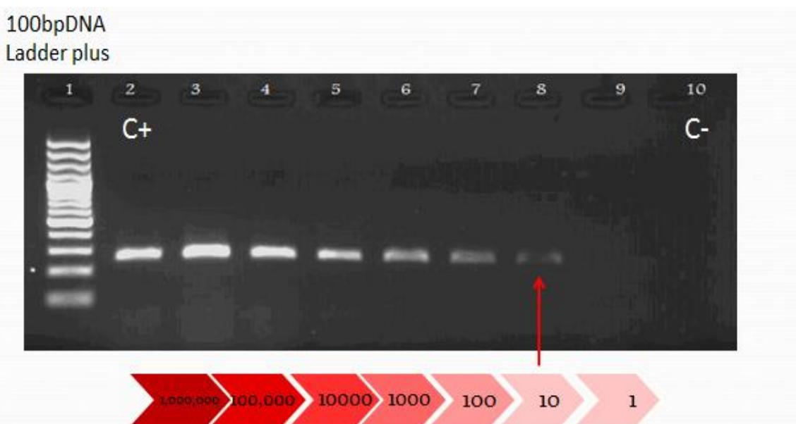
شکل ۱. حساسیت تست تشخیص PCR جنس مایکوپلاسمای لاین ۱: سایز مارکر 100 bp DNA Ladder plus. لاین ۲: کنترل مثبت، لاین ۳ الی ۹: به ترتیب یک میلیون، صد هزار، ده هزار، هزار، صد، ده و یک مایکوپلاسمای ازای هرو واکنش، لاین ۱۰: کنترل منفی.
